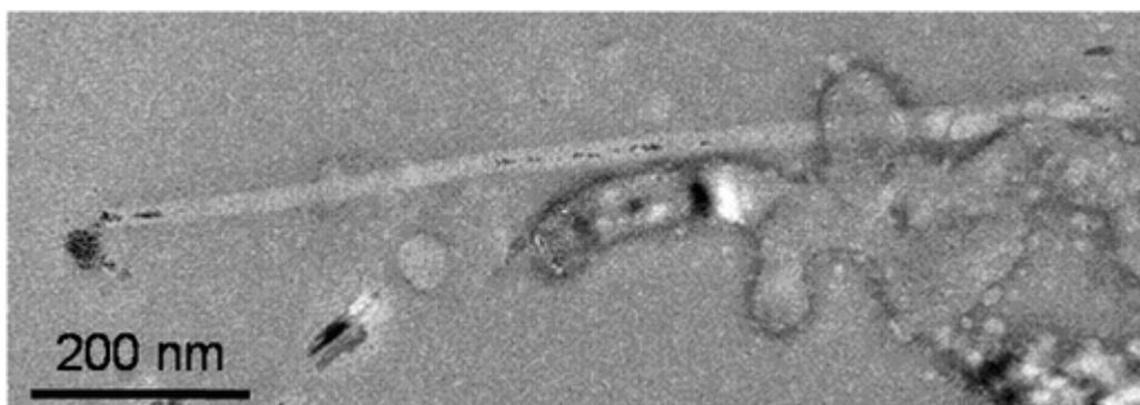
図 5-18 マイナスチャージ導入 ToMV に振とう攪拌法でコバルト白金ナノワイヤ作製を試みた時の透過型電子顕微鏡像 染色：1%金グルコース
