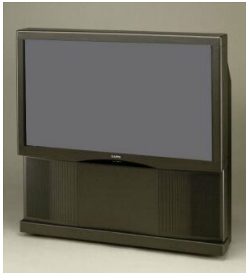
写真 2 カラーグレーティング方式 40インチリアプロ TV
