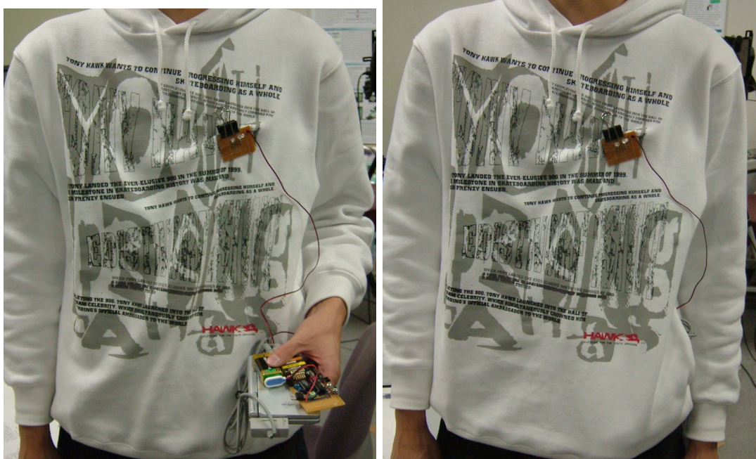
図 4.2 ユーザ側システムを携帯している様子:左図で持っている PDA と IR タグの回路部を右図ではポケットに収納している
