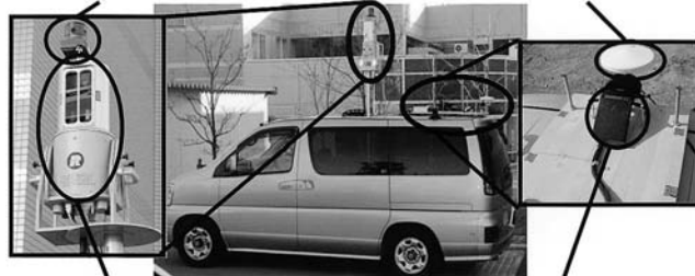
全方位カメラ(Point Grey Research, Ladybug) RTK-GPS(ニコントリプル, LogPakII)
