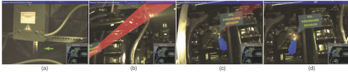
Figure 4 ネジを設置する際の情報提示方法 (a) の緑の矢印で、目標場所までの頭の回転を促す．(b) の半透明の 3D 矢印で視点移動を促す．(c)(d) 目標場所に到達すると、矢印は消えてき、次の作業、正確な位置を示す 3D モデルが現れる．
