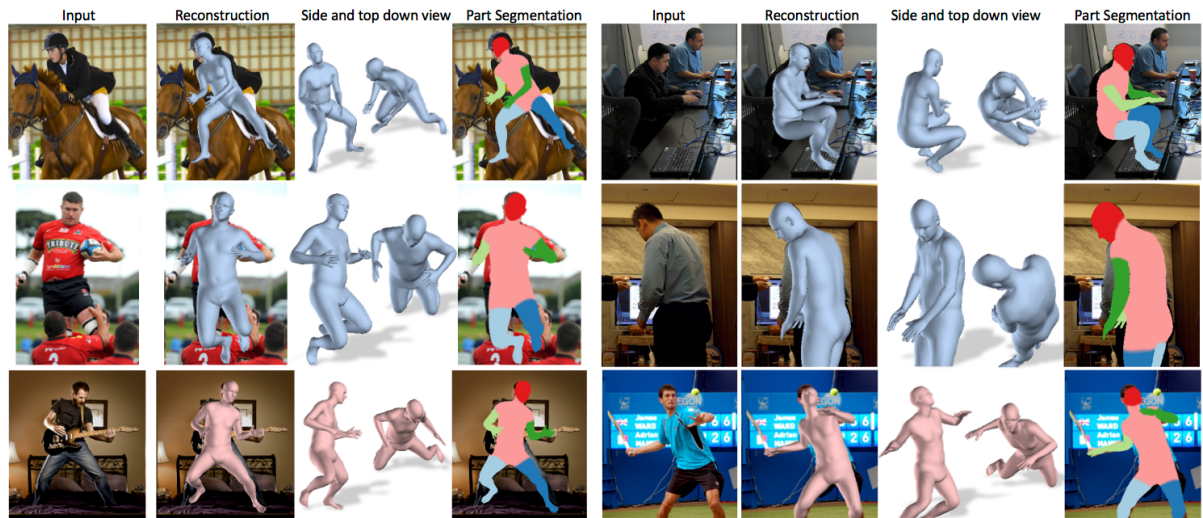
図 2.2 3次元人体モデルを用いた3次元位置姿勢推定の例 [16]
