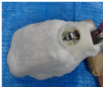
(g) Pour Hitohadagel into the mold again
