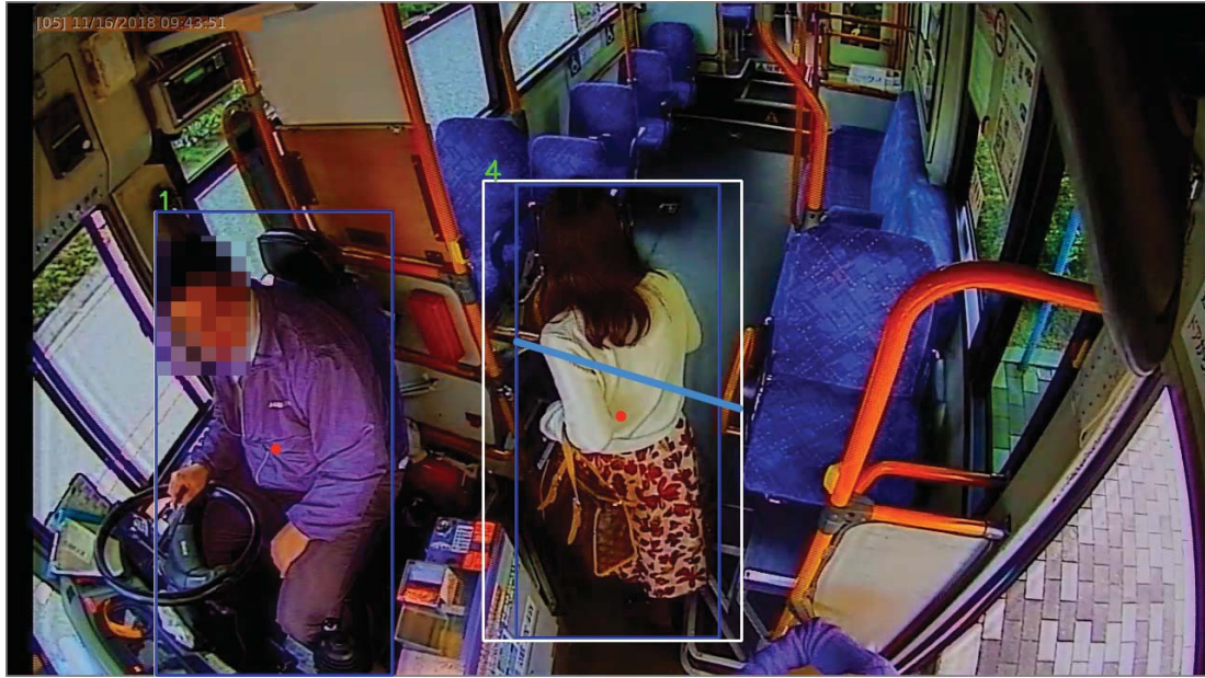
図 16: YOLOv3+Deep SORT を用いたときのサンプルフレーム
