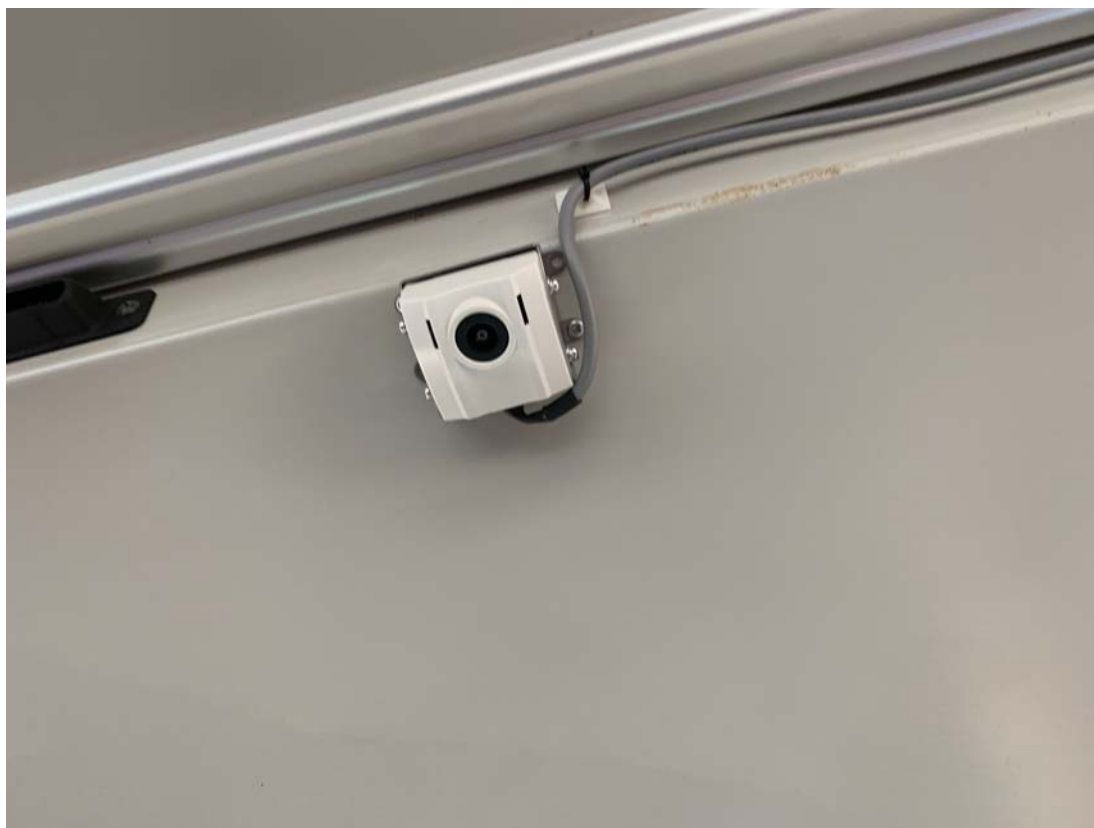
図 6: バス乗降客カウントセンサ PASSENGER COUNTER の取り付け例
