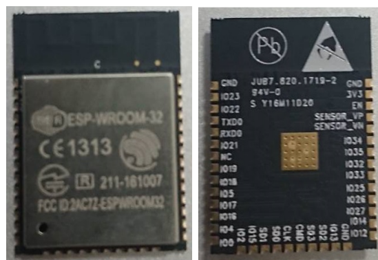
図 13 esp32 の外観 左:表面, 右:裏面
