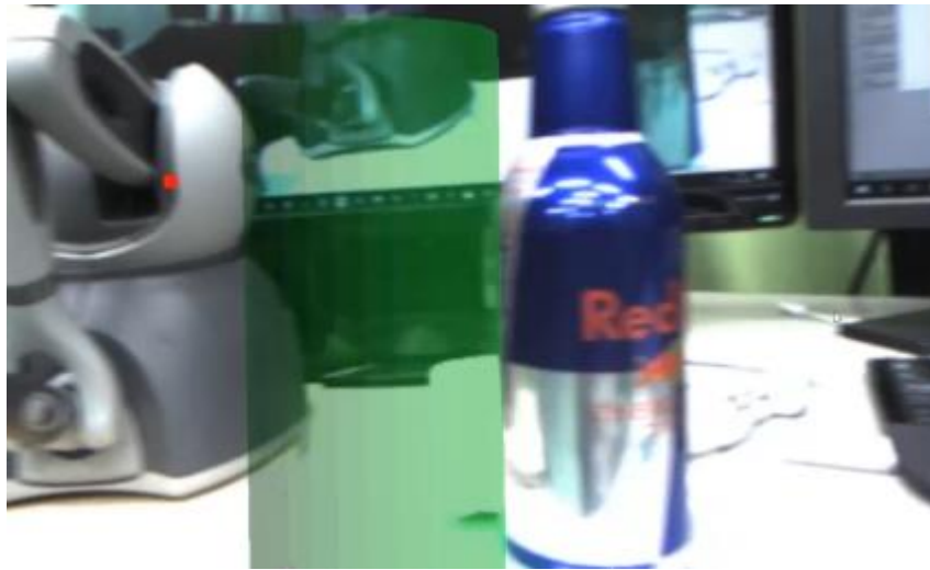
図 13 HMD を動かしした際の仮想オブジェクトのずれ
