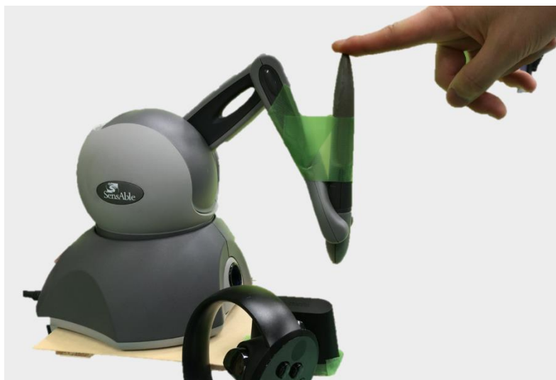
図 9 ハプティックデバイスと実験における使用方法
