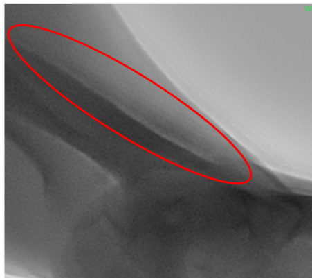
図 4.14 X 線動画画像上に発生されるモーションブラー例．赤い線の領域で囲まれている部分に前フレームの輝度値が影響し，エッジのようなものが生じている．
