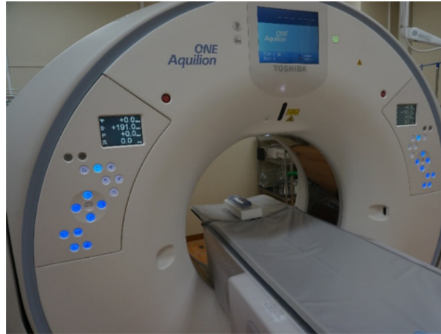
図 3.1 CT 撮影時の様子．撮影時にはシート面と接着させないために放射線を透過する発泡スチロールの上に撮影対象を置き，骨軸方向に向けて全体を CT スキャンにかけている．
