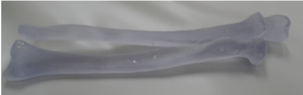
図 3.2 実験に撮影した樹脂製模型骨．示されている図は金属球付着前の模型骨であり，事前に用意した窪みの位置に金属球をテープで付着させ撮影を行なった．
