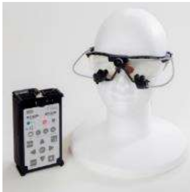
(a) 視線計測装置(EMR-9)
