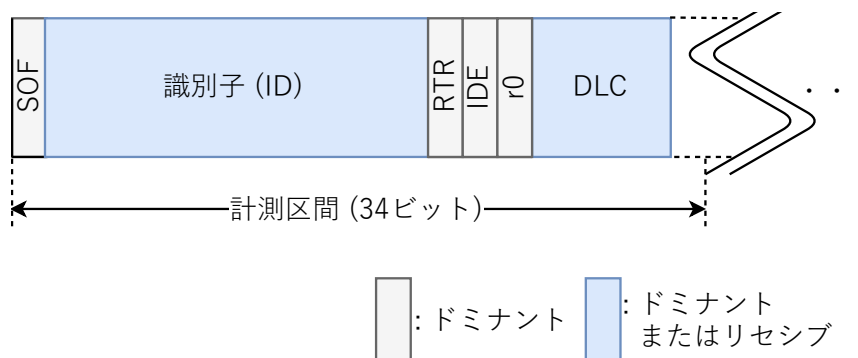
図 20 プロトタイプにおける 1 フレームあたりの計測区間
