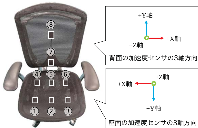
図 17 センシングチェアに取り付けた加速度センサの番号割り当ておよび3軸方向
