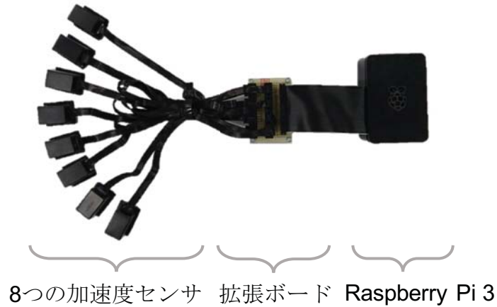
図 5 Raspberry Pi 3 の GPIO ピンに拡張ボードを通して接続した加速度センサ
