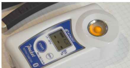
図 7: 屈折糖度計. 金属のポケットに果汁を滴下し糖度を計測する. 温度によって屈折率が変化するため, 実験のはじめに室温程度の水を Brix 値 0 として補正する.
