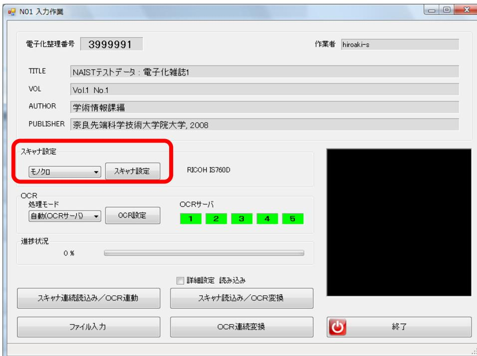
全頁をモノクロで、オートドキュメントフィーダ（ADF）により両面を同時に読み込んで、本文のイメージデータ（画像データ）を作成します。ここで作成されるのは、TIFF フォーマットのイメージデータです。また、スキャナ読み込みと同時に、OCR 変換を行うことにより、テキストデータが作成されるとともに、TIFF フォーマットのイメージデータとテキストデータから、頁単位の透明テキスト付き PDF が作成されます。
